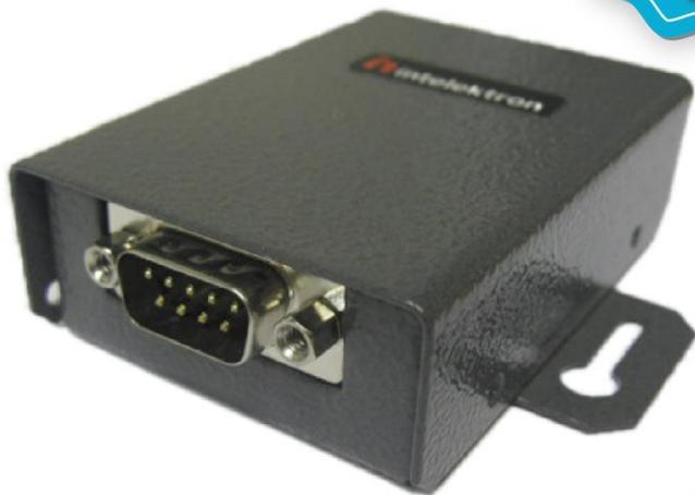
Cuando se instala un solo equipo, que no sea autónomo y se quiere usar con algún software configurador, se conecta directamente al puerto RS-232. Sin embargo, cuando se arma una red con varios controles de acceso es necesario utilizar estos equipos, que convierten la salida RS-232 de la PC a TCP/IP para permitir el vínculo de comunicación entre la PC y los equipos.
